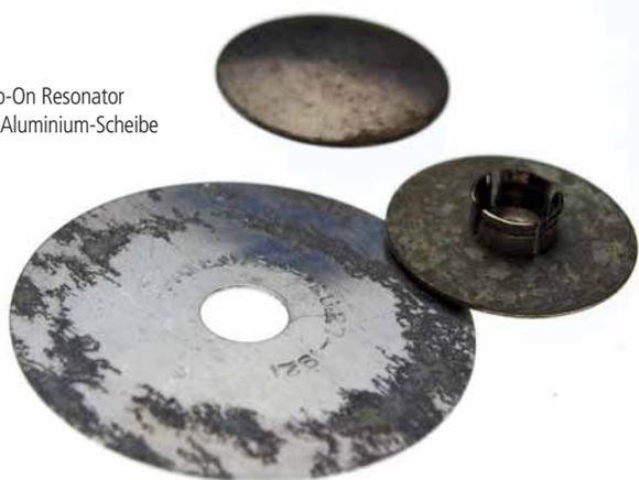
Reso-Pads links mit Kunststoff-Folie, rechts mit Bleifolie, hinten neues Ersatzpolster von Ferree's
