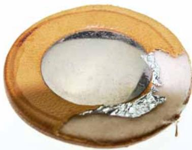
Altes Lederpolster mit geschlossenem konvexem Metallresonator und Bleifolie
