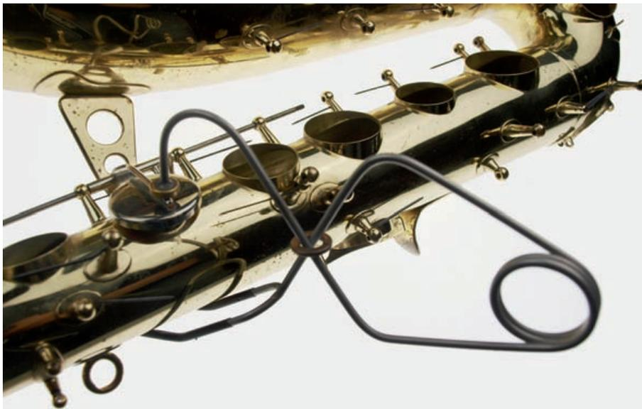
Die erste Klappe wird eingebaut und justiert, erwärmt und mit der Polsterklammer fixiert
