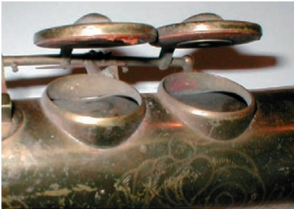
Lyon & Healy Sopran: defektes Tonloch Aufgelötete Tonlöcher auf einem als Lyon & Healy markierten Martin Bb-Soprano – beim linken Tonloch ist zu erkennen, dass die Lötung nicht mehr dicht ist, ein typisches Problem bei solchen Tonlöchern.
