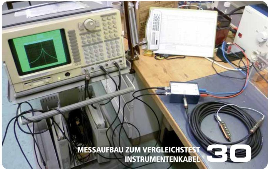
MESSAUFBAU ZUM VERGLEICHSTEST
