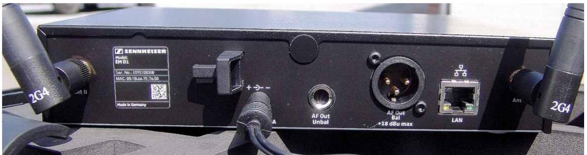
Sennheisers ew D1 System funkt nicht nur digital, sondern lässt sich über den rückseitigen Netzwerkanschluss auch digital fernsteuern
