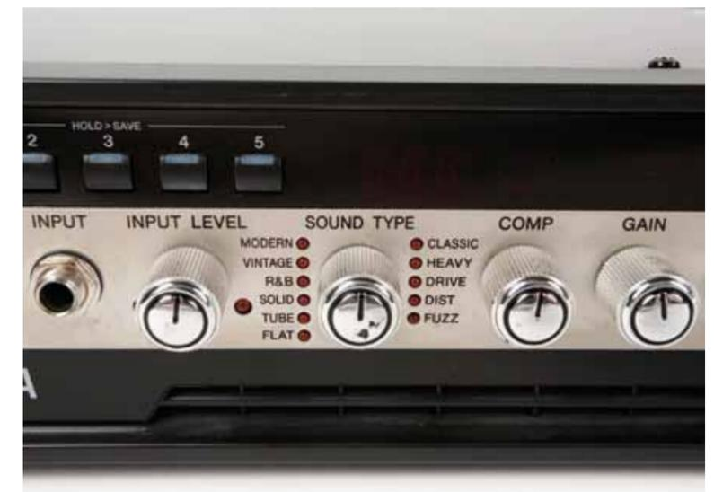
Amp in den Kompressor-Modus: Beinahe alle Regler haben jetzt eine andere Funktion. Zum Glück werden die geänderten Funktionen im LED-Display oberhalb der Regler angezeigt. Und die Einstellwerte werden im kleinen Nummerndisplay ebenfalls angezeigt. Ich kann den Kompressor sehr genau nach Kompressionsverhältnis, Attack- und Release-Zeit, Gain und Knee einstellen. Zusätzlich besteht die Möglichkeit, das Noise Gate und das Mischungsverhältnis des parallelen Effektweges zu regulieren.
