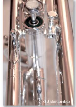
heren Blaswiderstand, kann man mit dem Soundpost die Vorteile der Tuning Bell Trompete hinsichtlich des Schallstückwechsels nutzen und ein nahezu gleiches Spielgefühl wie mit den festverlöteten S-Stützen erreichen.
