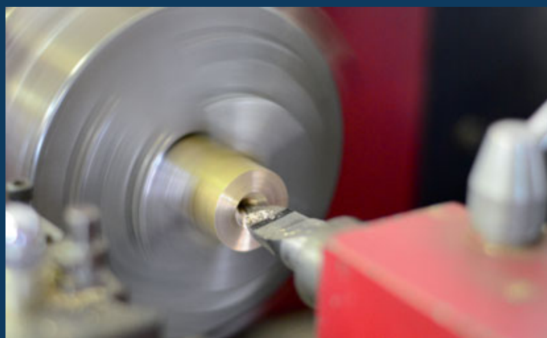
Der Mundstückkessel beim Ausformen
