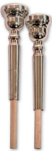
Unterschiedlichen Konusverlauf der Bohrung, mit zwei Bleistiften gleicher Länge ermittelt, die unterschiedlich tief in die Rückbohrung der Mundstücke gehen.
