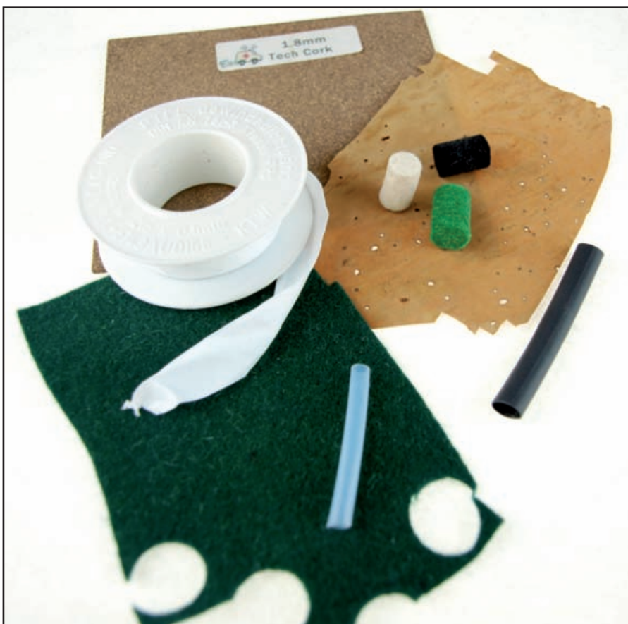
Bild 6: Dämpfungsmaterial: Grüner Filz, Teflonband, Gummikork (TechCork), dünner Naturkork, Filzzylinder, Schrumpfschlauch (schwarz), Teflonschlauch (weiß, sehr glatt, z. B. für Oktavhebel)
