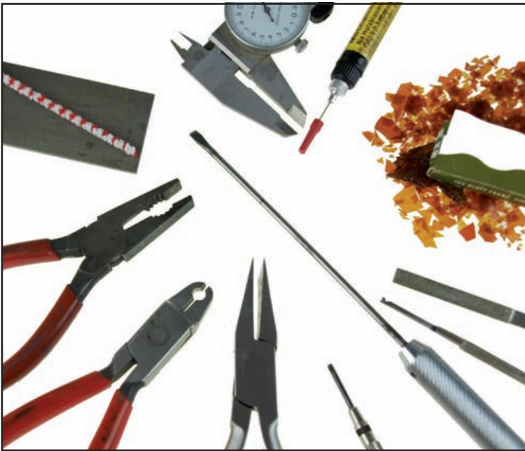
Bild 1: Zangen/Schraubendreher: Im Uhrzeigersinn, beginnend oben: Schieblehre, Öladel, Schellack-Flocken und Zigarettenpapier, kleine Feile, Federhaken, großer Schraubendreher, kleiner Schraubendreher, breite Zange zum Richten von Klappen, Zange zum Ziehen/Verlängern von Achsführungen und Lagern, Standardzange, Tonlochfeile und Pfeifenreiniger
