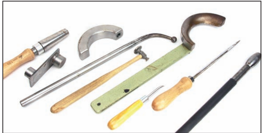
Bild 3: Ausbeulwerkzeug: Ausbeulwerkzeug (von links): Roller, Werkzeug zum Richten eines verzogenen Korpus, Stahl zum Ausbeulen des unteren Bogens (Knie), Ausbeulstange für S-Bögen, Ausbeulhammer, Sichel zum Richten von Schallbechern, kleiner und großer Polierstahl, Ausbeulstange mit ovalem Endstück
