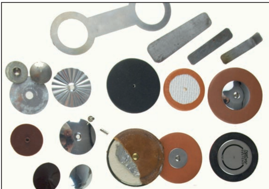
Bild 5: Polster: Von links oben nach rechts unten: vier Polsterbleche, zwei original Buescher Snap-On-Knöpfe und Aluminium-Scheibe, wie sie unter den original Buescher Snap On Pads angebracht war. Noyek-Style-Resonator, schwarzes Roo Pad ohne Resonator (aber mit Loch), Rückseite eines Pisoni Premium Deluxe-Polsters mit Loch, Musicmedic Precision Polster mit Resonator und Nieten, Plastik-Resonator (Rückseite), einzelner konvexer Metallresonator, Nieten, Ferree's Plastik-Resonator mit Spitze, glatter Metall-Resonator, aufgeschnittenes original Conn Res-O-Pad mit Metallring und Bleifolie, neues Reso-Pad-Style Pad, Toptone-Polster
