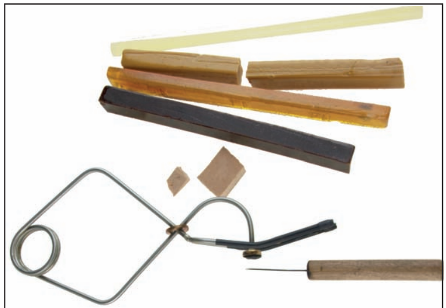
Bild 4: Polsterwerkzeug: Von oben nach unten : Heißkleber für Pistole, Siegelack (gelb), Schellack (amber), Schellack (braun), Keile aus Kork, Polsterklammer, Nadel mit Griff zum Herausheben und Justieren von Polstern
