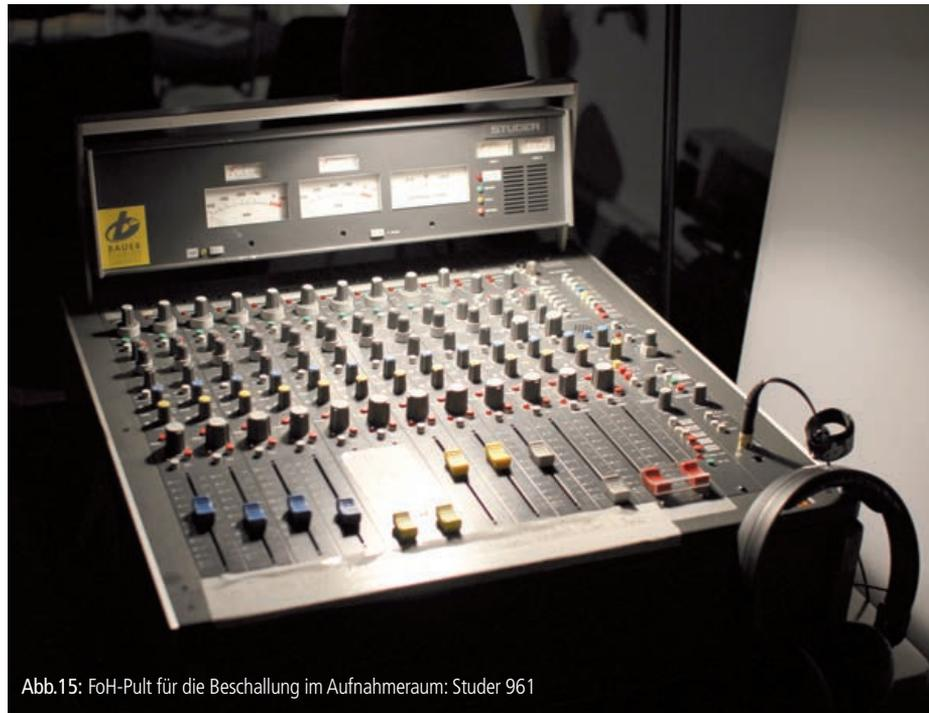
Abb.15: FoH-Pult für die Beschallung im Aufnahmerraum: Studer 961
