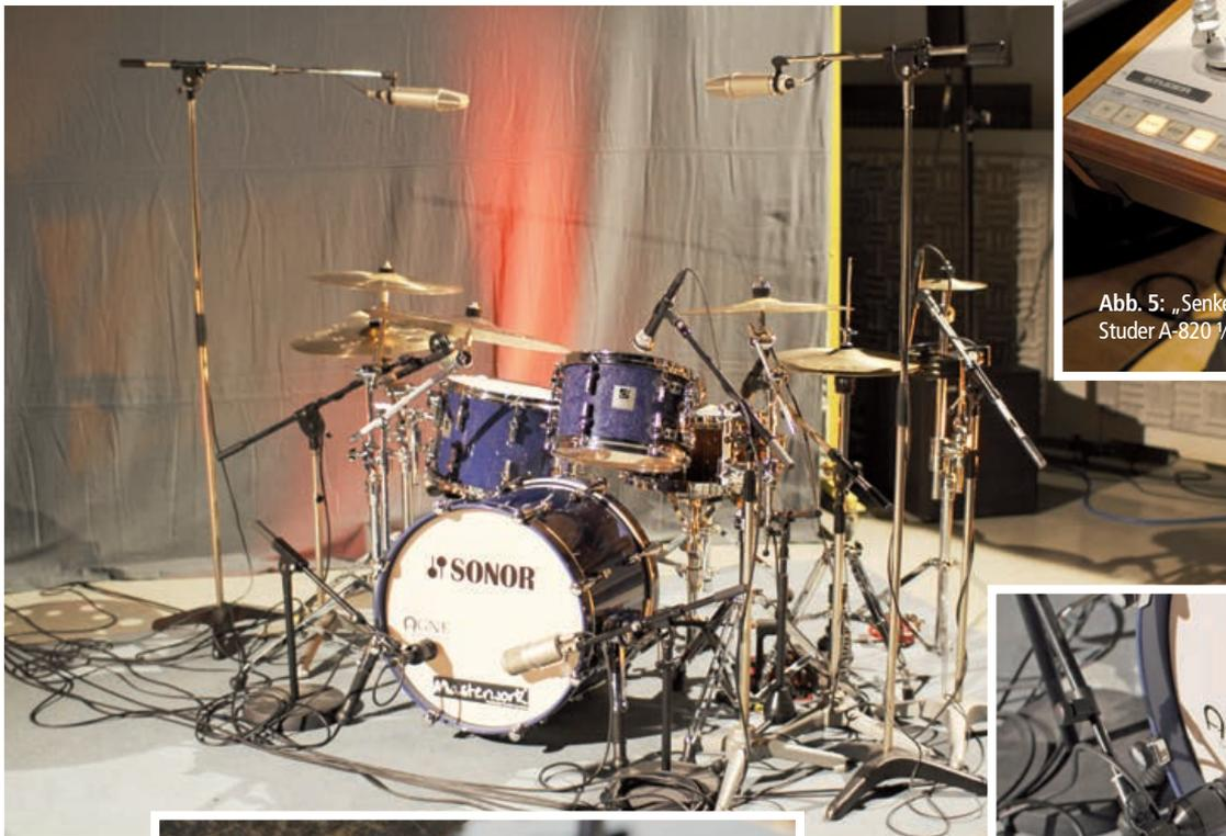
Abb. 6: Schlagzeug-Mikrofonierung: Heck verwendet zwei Neumann U-67 als Overheads
