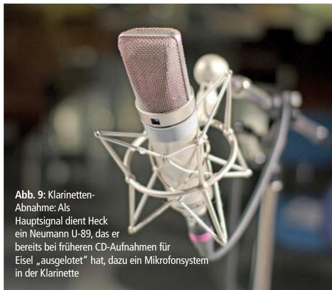
Abb. 9: Klarinetten-Abnahme: Als Hauptsignal dient Heck ein Neumann U-89, das er bereits bei früheren CD-Aufnahmen für Eisel „ausgelotet“ hat, dazu ein Mikrofonsystem in der Klarinette
