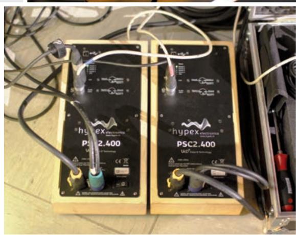
Abb. 14: Das System wird von zwei Hypex Electronics PSC-2.400 Class-D-Endstufen gespeist
