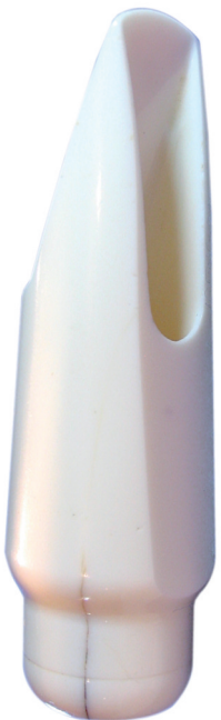
Leider keine Seltenheit: Gerissener Schaft an einem alten Kunststoff-Mundstück, hier ein Buescher True Tone Tenor-Modell.
