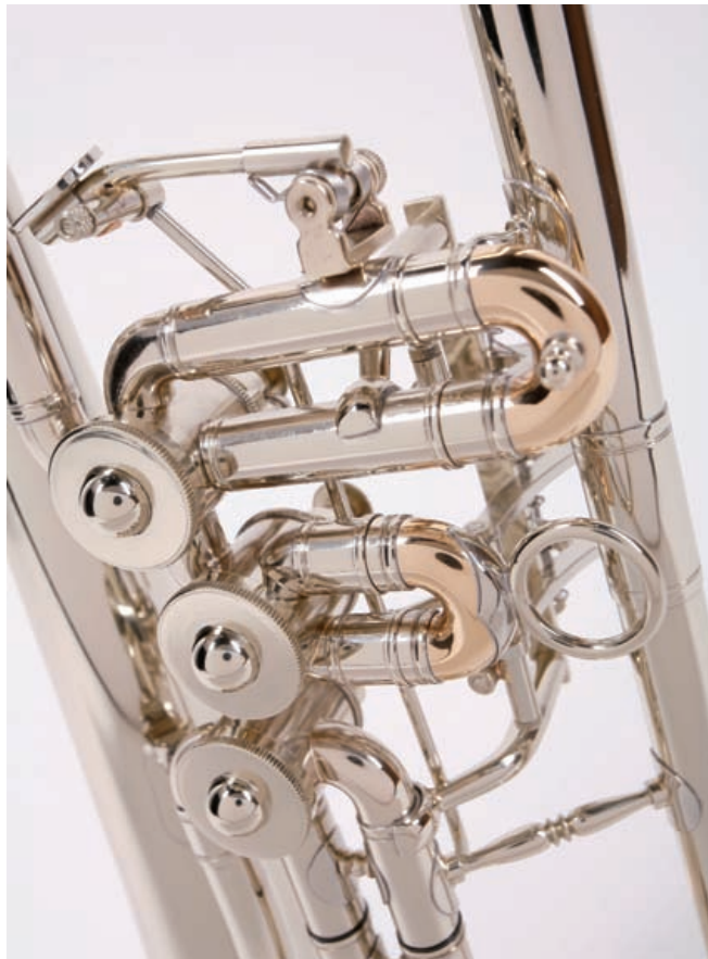
Im 90 Grad Bogen: Mundrohrführung zum ersten Ventil (oben links)
