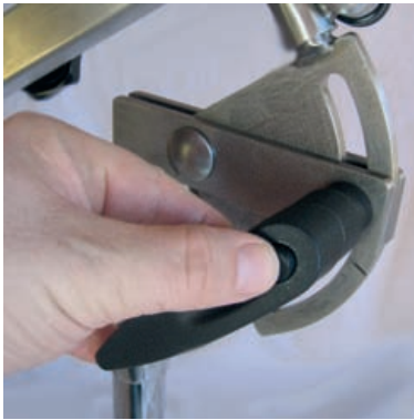
Durch Eindrücken des Knopfes kann der Hebel in eine andere Stellung gebracht werden.
