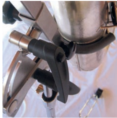
Mit dem oberen Hebel kann das Instrument seitlich geschwenkt werden.
