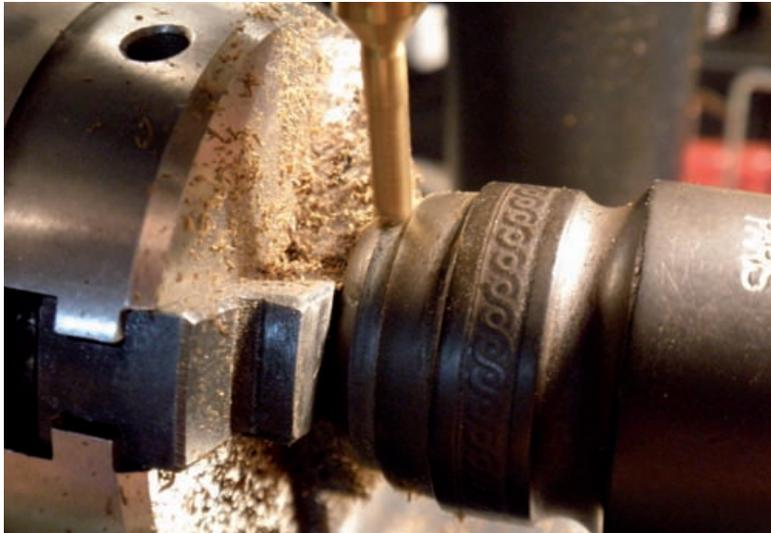
Für den Verstärkungsring wird eine Nut eingefräst
